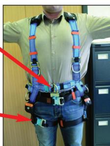
ancoraggio ventrale spostatosi in posizione sternale dopo caduta
